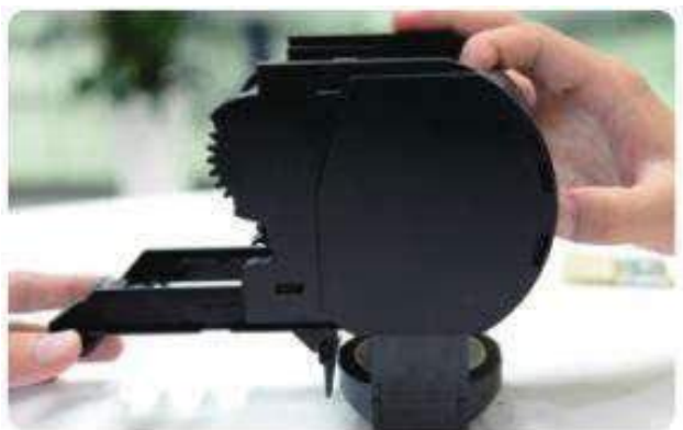
Вытяните ползунок скребка шлака
