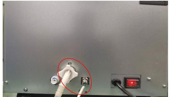
Другой конец погружного насоса подключается к входу воды кофемашины и разъему питания погружного насоса.
