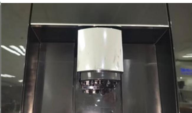
Очистите нижнюю часть рычага носика с помощью щетки (нажмите [Промывка] -> [Кофе машина] -> [Промывка всего], когда носик выйдет, очистите нижнюю часть рычага носика с помощью щетки).
