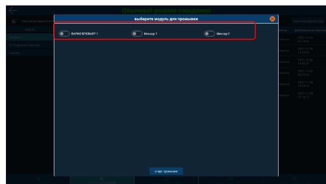
Войдите в интерфейс [Главная вкладка очистки], нажмите “машина” для ручной очистки [промывка всей системы], [промывка только указанных модулей]; очистка [промывка всей системы]- все трубы промываются по очереди; [промывка только указанных модулей] - это выбор соответствующего модуля и активация кнопки, нажмите [старт промывки], горячая вода промывает только выбранный модуль.
