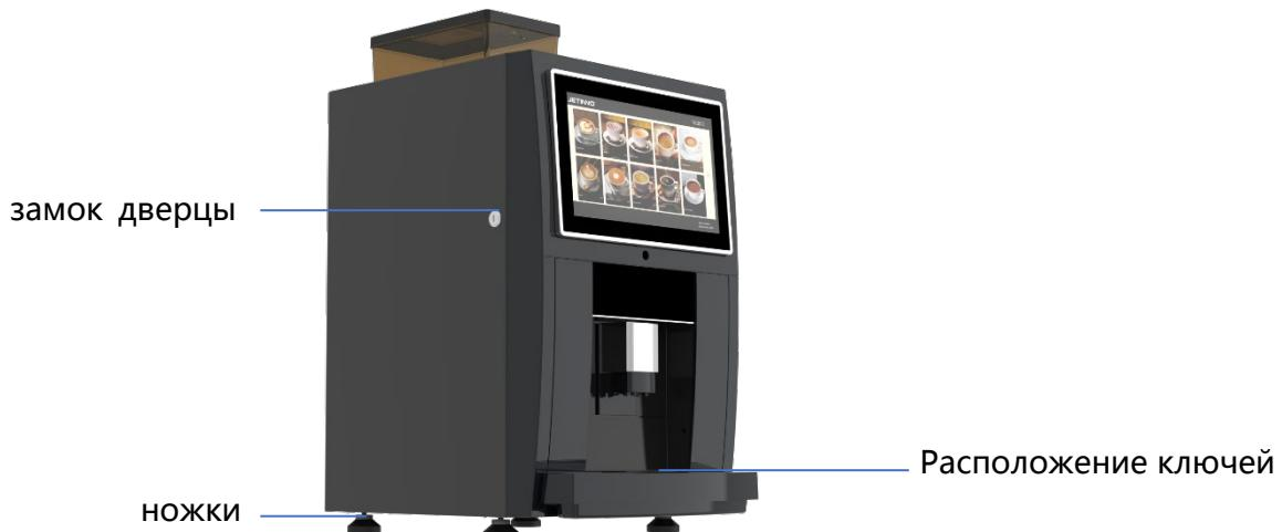
Откройте замок дверцы кофемашины и проверьте внутреннюю часть кофемашины на наличие повреждений. Снимите напольные ножки и установите их .
