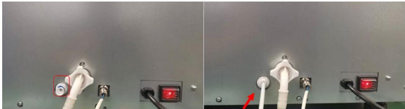
Снимите синюю защелку, нажмите на всплывающую сторону фитинга, вытащите заглушку и вставьте один конец слива в быстроразъемное соединение, а другой конец поместите в раковину или в ведро для сточных вод.
