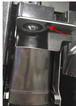
Два выступа в нижней части заварника должны соответствовать двум направляющим пазам на приводе заварника; установите два выступа в соответствующие направляющие пазы и с силой толкните заварник до щелчка; нажмите пальцем на защелку внутрь, чтобы убедиться, что защелка заварника заблокирована.
