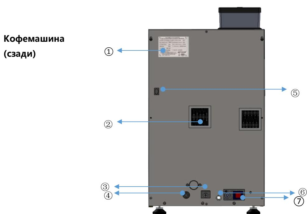
① Заводская табличка кофемашины, ② Воздуховыпускное отверстие; ③ Питание и выпуск водяного насоса; ④ Сливные соединения бойлера, ⑤ Разъём MDB, ⑥ Выключатель питания; ⑦ Прямой вывод в канализацию
