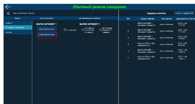
Модуль ES Кофейный заварочный блок[быстрая очистка]; Модуль Миксер [быстрая очистка], Автоматическая очистка : установка автоматического интервала очистки, очистка по времени; Можно настроить: всю машину, кофейный заварочный блок, миксеры
